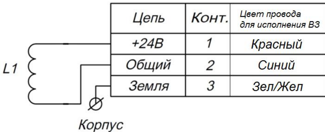
Рисунок А.3 Схема электрическая принципиальная подключения устройства электромагнитного пуска типа УЭМП
